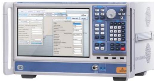
Le TE3267 est le nouveau générateur RF de Transcom. Il permet de générer des porteuses jusqu'à 6GHz et de superposer des modulations analogiques (AM/FM/PM/PULSE) ou numériques (génériques/radiocommunication/Connectivité/IoT) dans la limite des 100MHz de bande passante.
