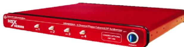
La série HSX9000 dispose maintenant de modules jusqu'à 40GHz avec des performances en bruit de phase exceptionnelles (-112dBc/Hz à 40GHz/10KHz de la porteuse). Les châssis permettent d'intégrer deux sources 40GHz dans 1U et les HSX9000 permettent la cohérence de phase dans un même châssis ou sur plusieurs châssis.
