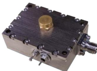
MITEQ introduit la famille LCDRO, des DRO disponibles de 7 à 18GHz avec d'excellentes performances en bruit de phase et une très faible sensibilité aux vibrations. De plus, ces modules acceptent une alimentation entre 5 et 15V et sont extrêmement compacts (50x30x15mm environ avec connecteurs) et très efficace en énergie.
